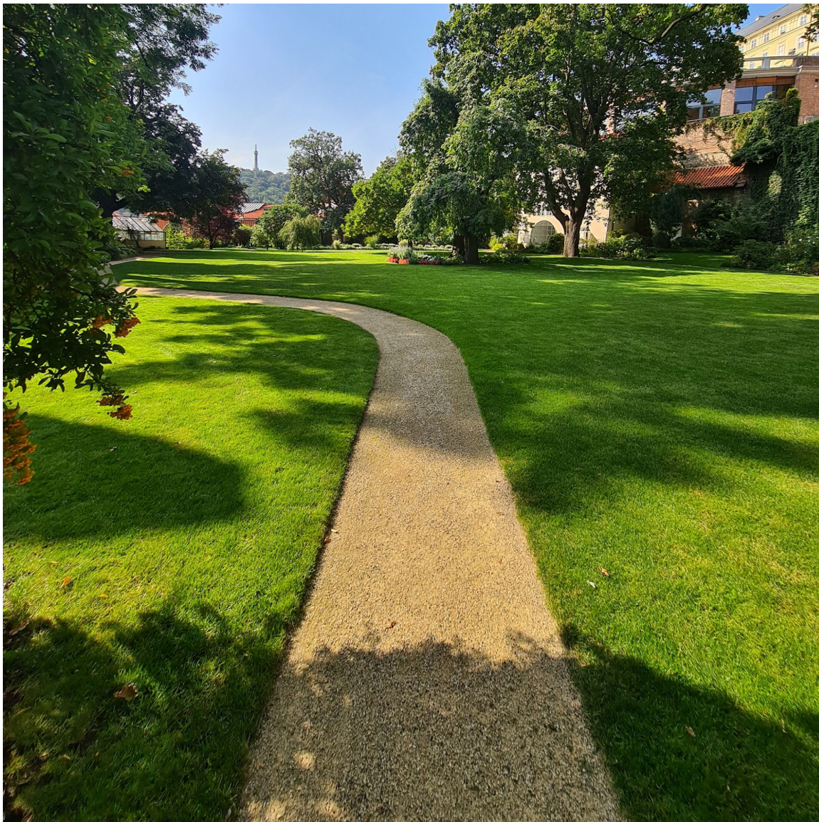
mlatová cesta v zeleni definována skrytou ocelovou pásovinou
